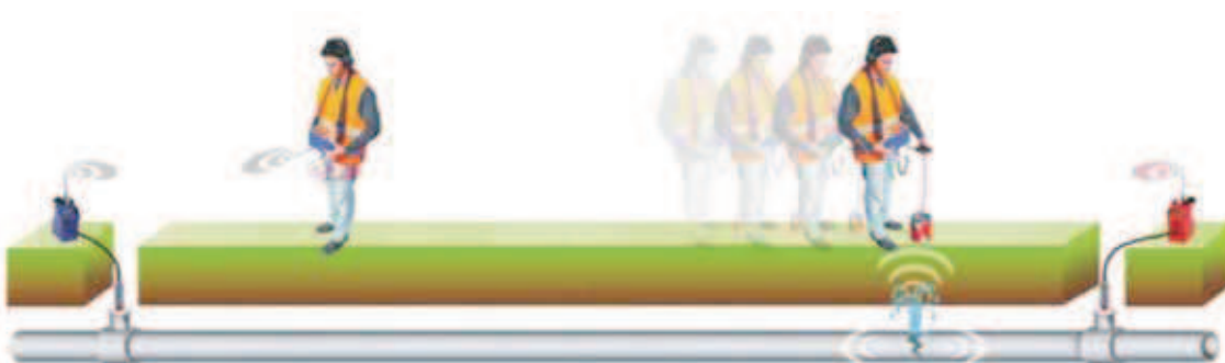
Osluchiwanie rurociągu przy pomocy mikrofonu ziemnego - funkcja geofonu [1]
