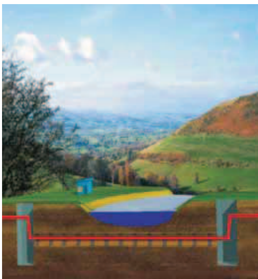
Rys. 2. Schemat przejścia pod rzeką
